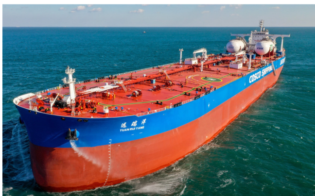
איור 21: מכלית הענק הסינית Very Large Crude Carrier, שהושקה בשנת 2022, כושר נשיאת מטען 317,800 טונות 64
